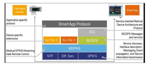
Fig. 2 SDC protocol stack (draft) for IEEE 11073 © Drägerwerk AG & Co. KGaA
